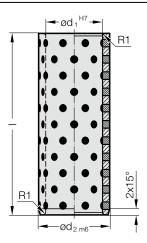
2052.71. Bague de guidage pour axe de ressort 2478.20. .1
