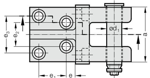
**2133.12. Chape avec axe avec sécurité par came à chute**
