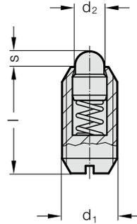
**2472.06. Poussoir à ressort, avec piston, avec fente, force du ressort augmenté**
