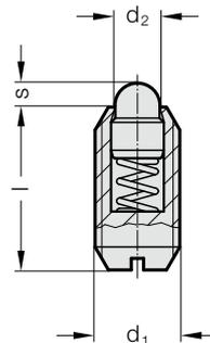
**2472.36. Poussoir à ressort, avec piston, avec fente, force du ressort augmenté**
